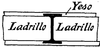
Fig. 906.—Sección de un poste de relleno.
