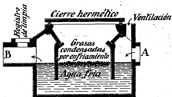
Fig. 1507. — Sifón colector de grasas sistema Hellyer.
