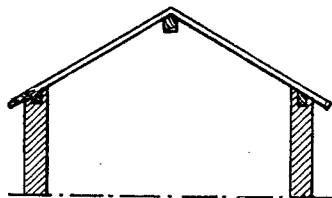
Fig. 757. Cubierta sobre piñones
