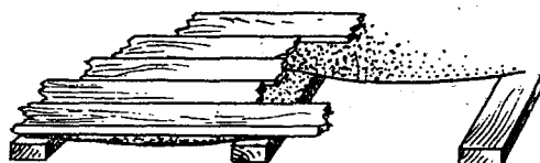
Fig. 1155. Empleo del cartón embetunado debajo de un entarimado.
