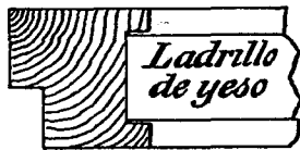
Fig. 1280. — Sección horizontal de una jamba o pie derecho de puerta.
