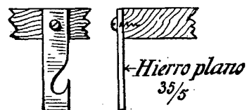
Figs. 969 y 970. — Ganchos intermedios de suspensión del cielorraso, para la escalera de la figura anterior.
