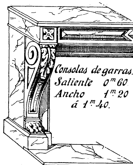
Fig. 519.—Chimenea de garras.
