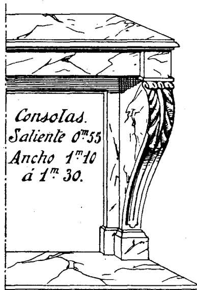
Fig. 518.—Chimenea de consolas.
