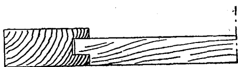
Fig. 1425.—Tablero enrasado a un haz.
