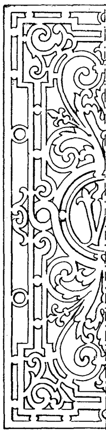
Fig. 1620.—Panel de chapa recortada para puerta (en lugar de los de fundición indicados en la figura 1312).
