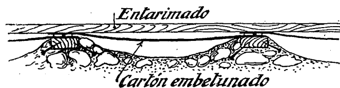
Fig. 1414. — Entarimado con aislamiento de cartón embetunado.
